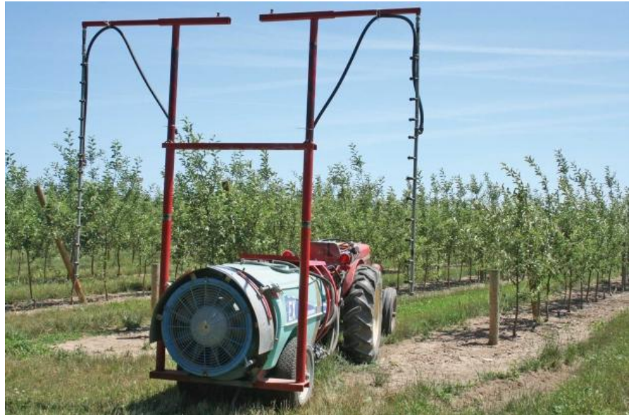
图 2-2 两行型康奈尔大学纺锤形树体喷雾机
