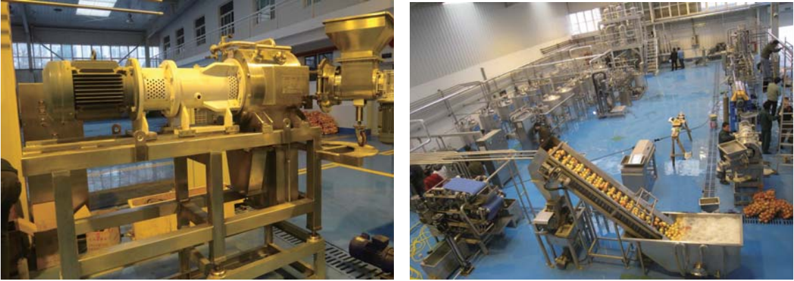
图 2 陕西师范大学自行研制的榨前分离设备和榨前分离果汁中试生产线
