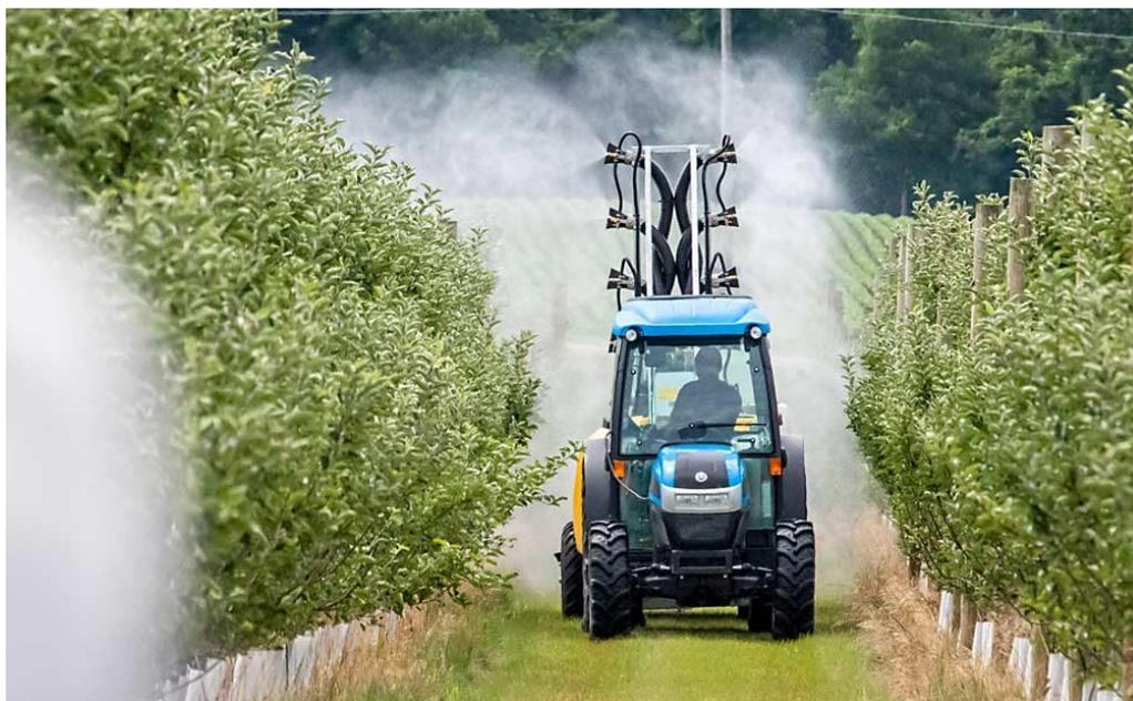
图 22-17 适当的喷雾方式以达到足够的树冠覆盖率
